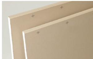
「マークボード」はビス位置が既に印字されたせっこうボードです。墨出し作業が不要になり、施工時間を削減できます。外国人の建設技能者に対しても、「言葉」ではなく、「画」で説明できるため、施工ミスを軽減できます。
